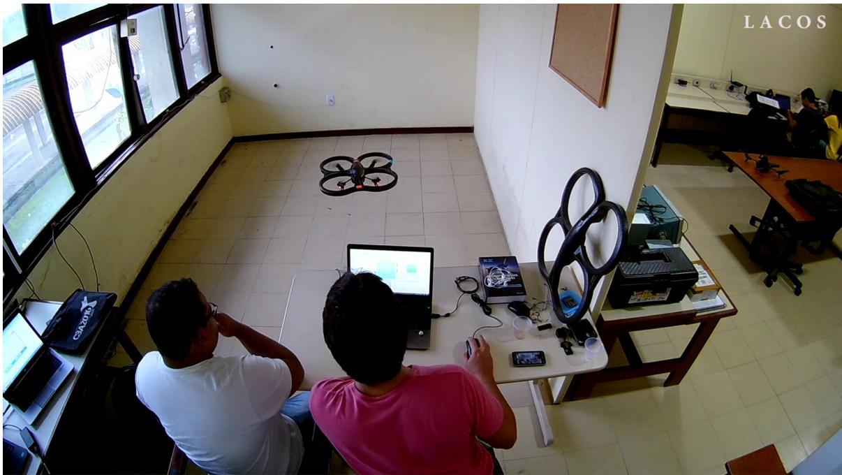
Fig. 1 – LACOS Local Positioning System mini flight room. Imagem extraída de vídeo informativo sobre o LPS (<https://youtu.be/w1NpsBH3TJM>).
