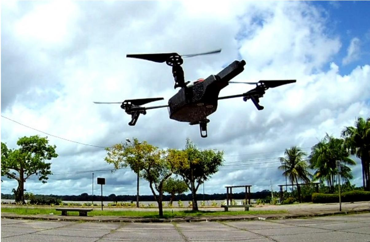
Fig. 10 – Foto extraída de [1] dos testes experimentais de sistemas de controle de voo em ambiente com ventos moderados. Experimentos fora do LPS com maior dedicação à navegação inercial e cenários reais de aplicação para validar as tecnologias desenvolvidas no projeto.
